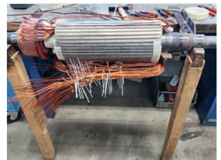
Bild 3: Immer noch Handarbeit – das Wickeln eines Ankers
