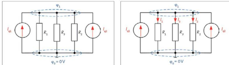
↙ Bild 3: Ersatznetzwerk mit Stromquellen (li.) - Bild 4: Definition der Stromrichtungen (re.)
