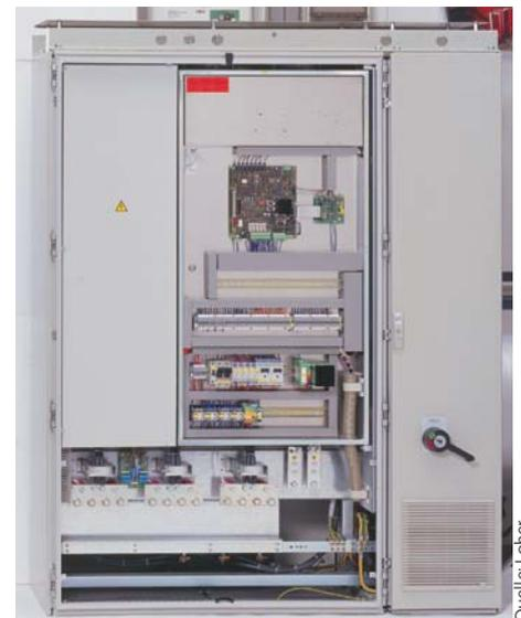
**Frequenzumrichter Dynavert T für 710 kW Wellenleistung und 690 V Netzspannung, sechspulsig; als zwölfpulsiger Umrichter wäre der Einspeiseschrank rechts 800 mm statt 400 mm breit und mit zwei Hauptschaltern ausgerüstet**
