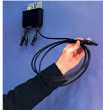
Bild 3: SolarEdge hat unter anderem seine Leistungsoptimierer für die Installation verbessert: Diese haben nun eine wesentlich kürzere Anschlussleitung auf der Modulseite, was den „Kabelsalat“ auf dem Dach stark reduziert
