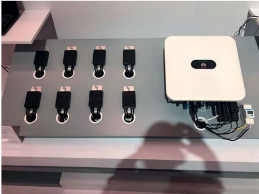
Bild 1: Bei Huawei wurde u.a. unter dem Titel »Smart Energy Center« dieser Hybridwechselrichter mit Leistungsoptimierern für PV-Leistungen von 3 kW bis 9 kW und zwei DC-Ausgängen (5 kW + 5 kW integrierte Batterieladung) vorgestellt
