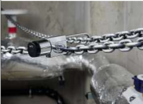
Bild 6: Elektronisches Vorhangschloss für die Sicherung von Betriebstechnik; andere in der Praxis bereits umgesetzte Einsatzgebiete sind z.B. Container oder auch Sektkühler
