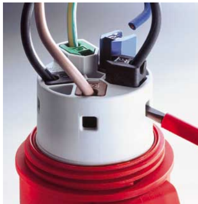
Bild 3: Schneidklemmen sind montagefreundlich: Leiter einlegen und Schieber schließen – fertig
