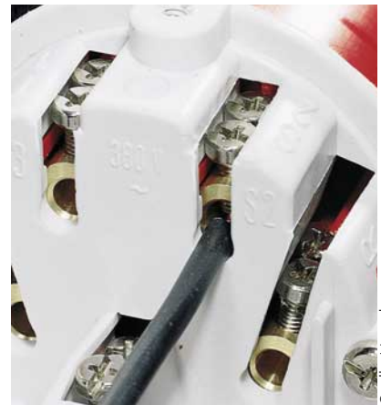
Bild 1: Buchsenklemmen benötigen groß dimensionierte Kontaktschrauben und Wandstärken, die Schraubkräfte sicher aufnehmen und sich nicht verformen; der anzuschließende Leiter muss ausreichend tief »eintauchen« können
